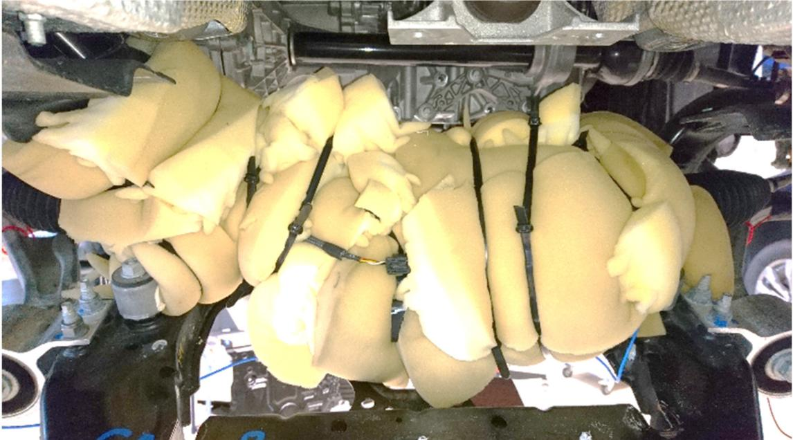
*Abbildung 4-3: Kapselung des Lenkgetriebes (Integralträger abgelassen)*
