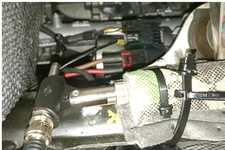
*Abbildung 4-4: Nahfeldmikrofon an der Kapselung (Lenkung im Hintergrund)*
