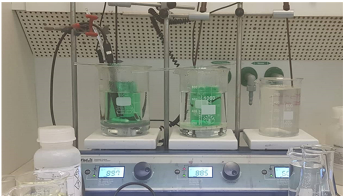
Abbildung 43: Versuchsaufbau chemisch Nickel Beschichtungsvorgang
