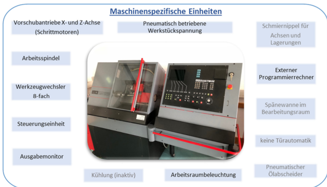
Abbildung 67: Komponenten der Drehmaschine EMCO 120P [51]
