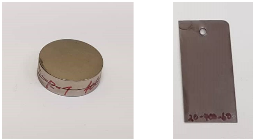
Abbildung 42: Probestkörper (100Cr6 Ronde und Stahlblech)
