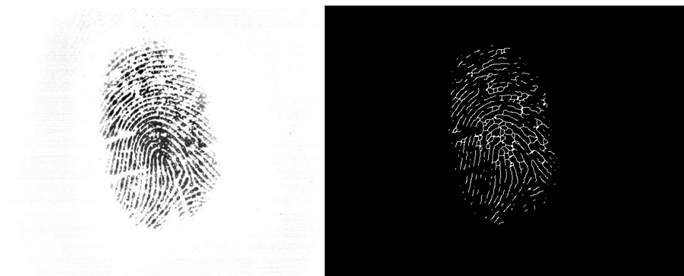
Abbildung 4.2: Ergebnis mit allen aktivierten Morph-Funktionen bei vorher erfolgter Binarisierung
