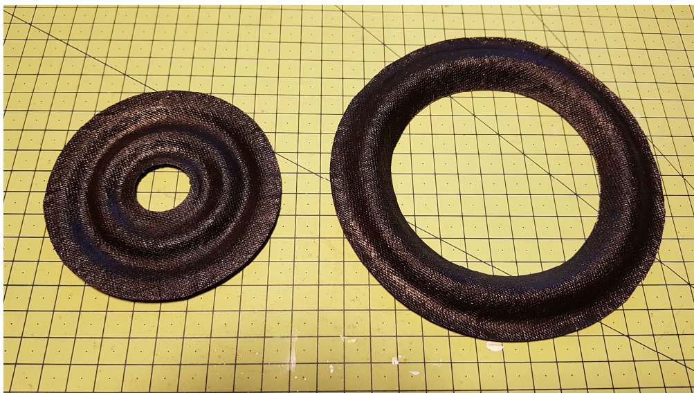
Abbildung 20: Fertige Zentrierspinne und Sicke [Jonas Richter, 2019]
