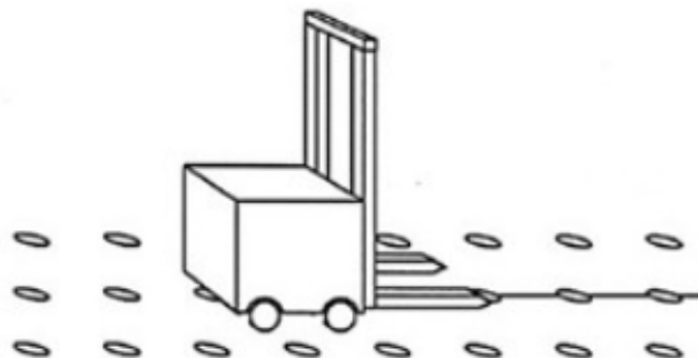
Abbildung 13: Rasternavigation (Rasterpunkte im Boden) [7]
