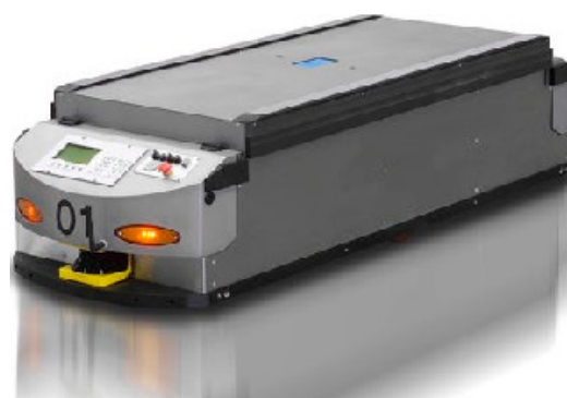
Abbildung 5: Ein FTS von DS AUTOMOTION 7
