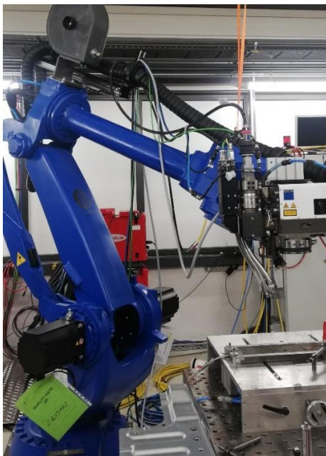
Abbildung 18: Roboter Comau MJ110 (Links) und dessen Arbeitsbereich (Rechts)
