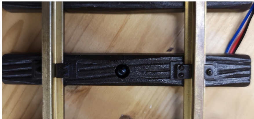
Abbildung 19: IR-Empfänger TSOP4840 installation
