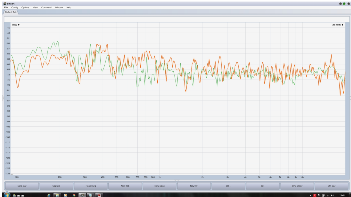
Abbildung 23 Frequenzmessung bei 10m (Grün=Alcons/Orange=d&b)
