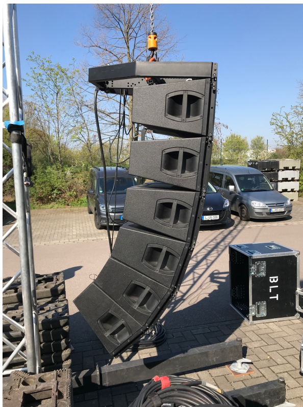
Abbildung 20 6 d&b Audiotechnik V8 Lautsprecher mit berechneter Winkelung
