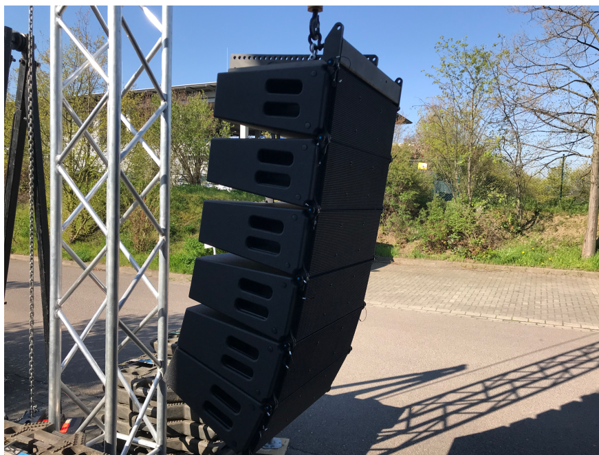
Abbildung 21 6 Alcons Audio LR18 Lautsprecher mit berechneter Winkelung
