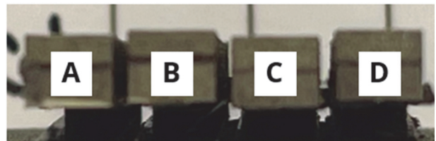
Bild 4: Spannung die den Cantilever nach dem Abtrennen vom Substrat hochhebt – Referenz (A), Streifenbestrahlung (B), Rechteck (C) und Schachbrett (D)
