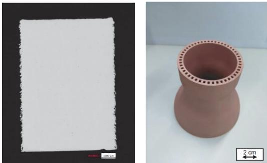
Abbildung 6: Schliffbild einer Probe aus CuCr1Zr (links); Demonstrator für eine Brennkammer (rechts). Bauzeit 10h 40 min.
