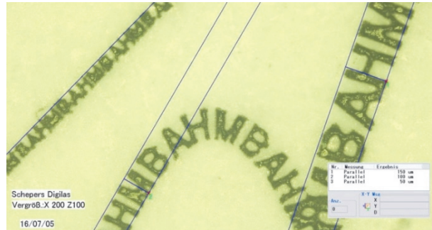
Abb. 20 In Kupfer gravierte Buchstaben Guilloches, Höhen 150 µm, 100 µm, 50 µm, Tiefe 50 µm
