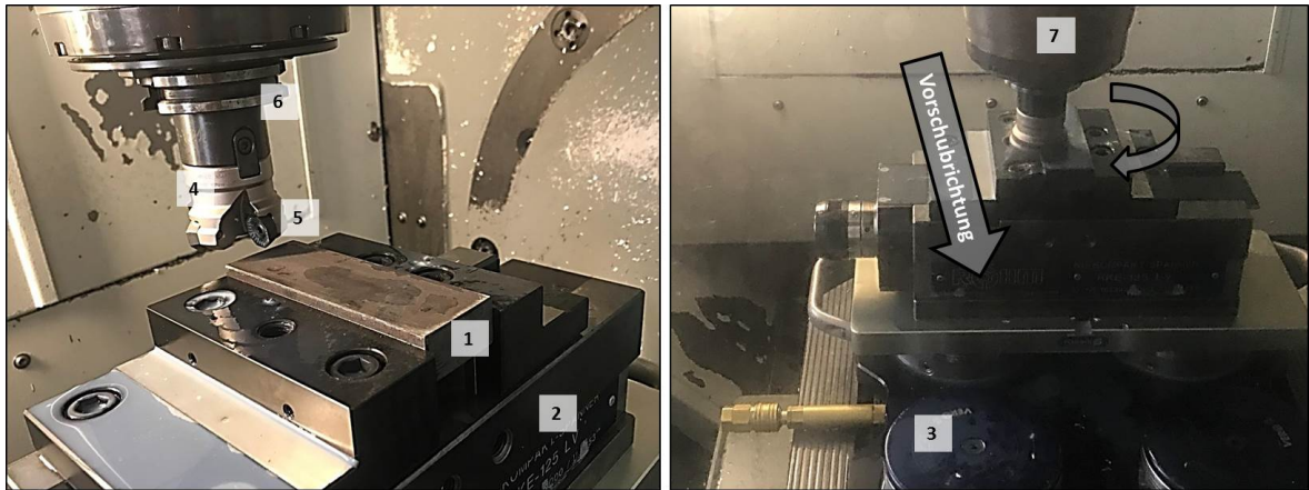
Abbildung 5.3: Versuchsaufbau der Kurzzeituntersuchungen im Stillstand (links), im laufenden Fräsprozess (rechts)
