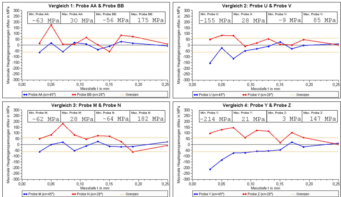
Abbildung 6.9: Grafische Darstellung der Eigenspannungstiefenverläufe in Abhängigkeit des Einstellwinkels \kappa_r der Versuchsreihe 1
