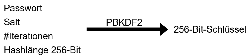
Abbildung 2.15: Schema für die Ableitung eines 256-Bit-Schlüssels aus einem Passwort mittels PBKDF2. Quelle: eigene Arbeit
