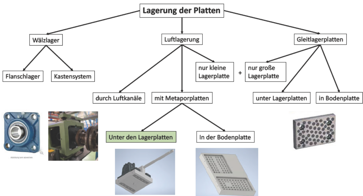
Abbildung 14: Schema für die Lagerung der Platten
