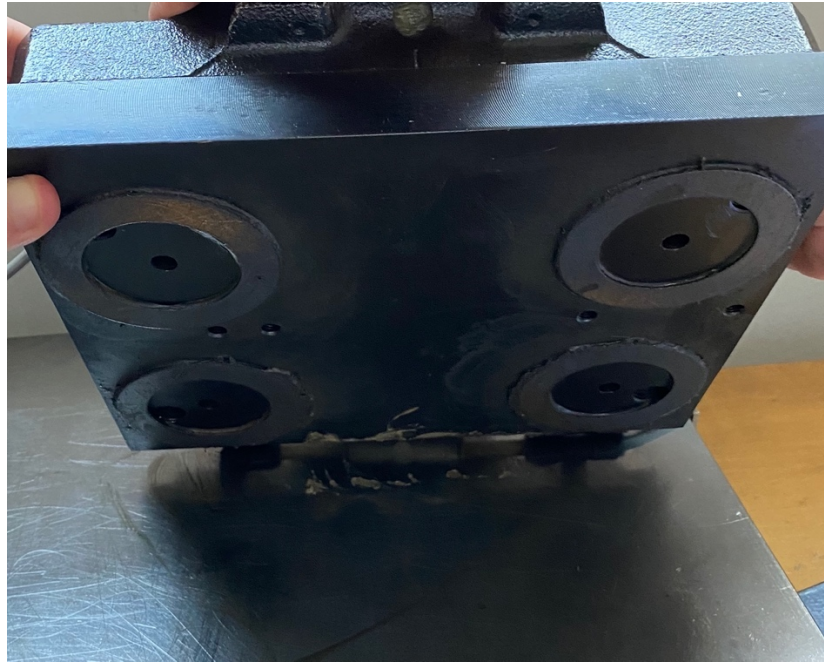
Abbildung 8: Auflagefläche der Luftlagerung
