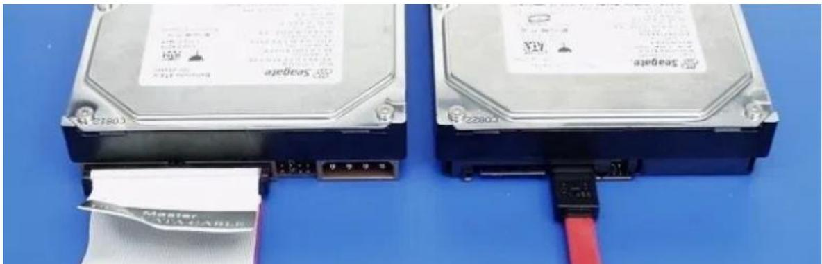
**Abbildung 8: PATA (links) und SATA (rechts) Anschlüsse [6]**
