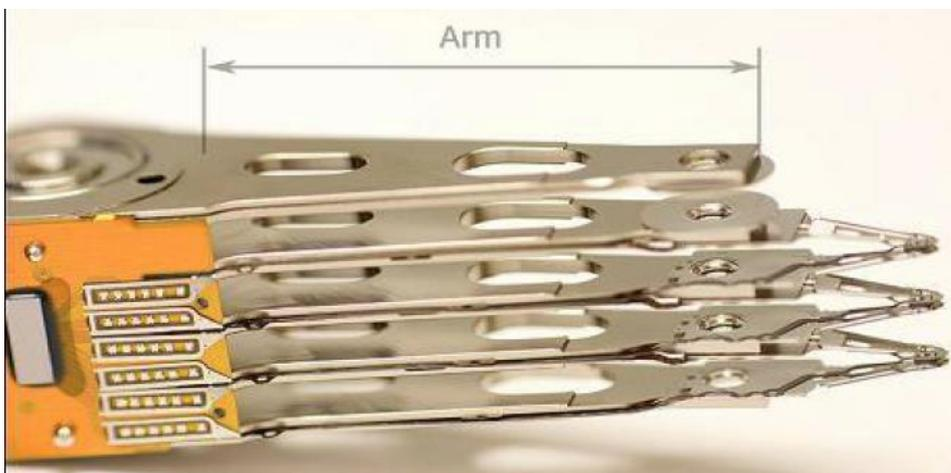
**Abbildung 4: Arm mit Aufhängung der Köpfe und Drehpunkt (links oben) [9]**
