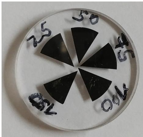
Abbildung 3.3: Tantal-Testbeschichtungen mit unterschiedlicher Dicke
