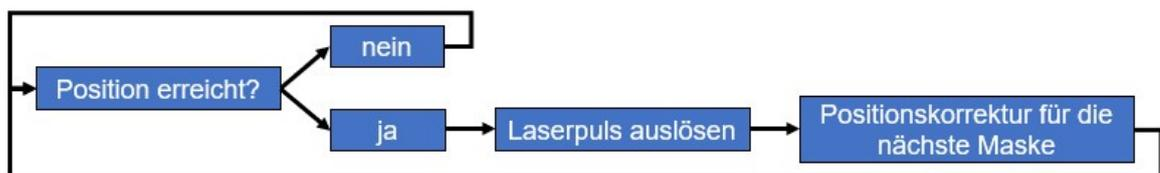
Abbildung 4.29: Programmübersicht: Positionsüberwachung während der gleichförmigen Bewegung der Drehachse
