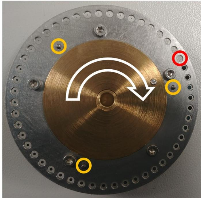
Abbildung 3.7: Maskenrad mit kreisförmig beschichteten Substraten (roter Kreis: kleinste Maske; gelbe Kreise: Positionsstifte; Pfeil: Drehrichtung während der Bearbeitung)
