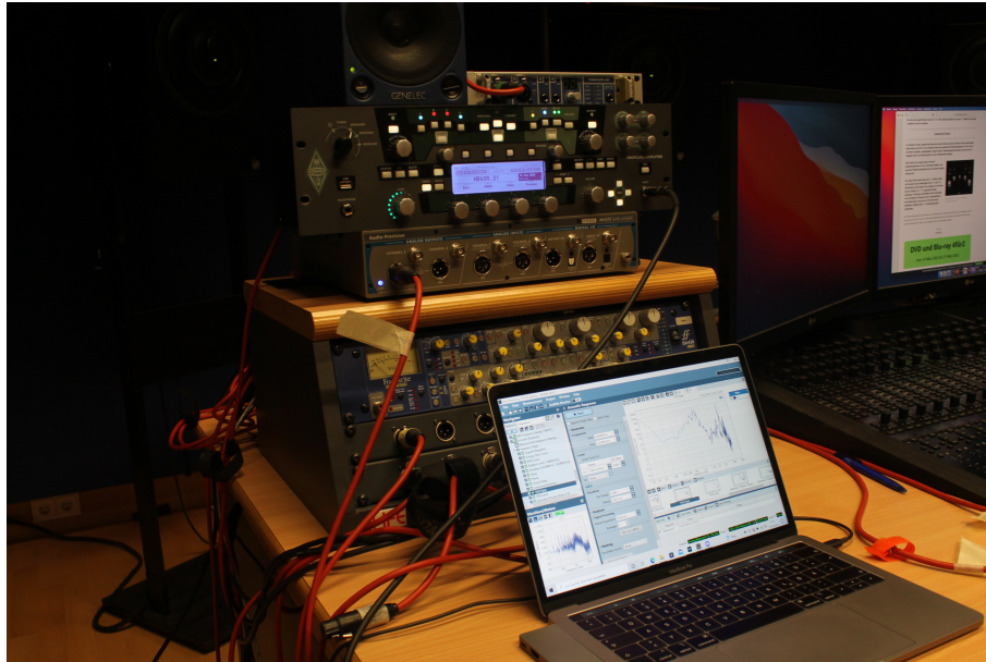
Abbildung 16: Anfänglicher Messaufbau in der Regie des Tonstudios der Hochschule Mittweida. Zu sehen sind im Vordergrund das MacBook, auf dessen Windows-Partition die APx500-Software lief, darüber das APx515B, der Kemper Profiler in der Rack Edition, das RME Fireface sowie ein aktiver Genelec-Lautsprecher, um über den Main Out des Kempers, die aufgenommenen Profile abzuhören.
