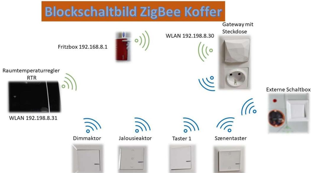
Abbildung 47 Blockschaltbild ZigBee
