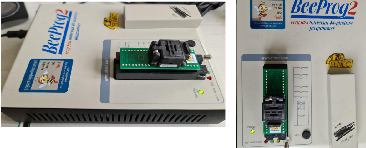
Abbildung 30: Spezial-Adapter DIL8/QFN8-1 ZIF-CS SFlash-1a im BeeProg2 (Eigene zusammengeschnittene Aufnahmen, Juli 2022)
