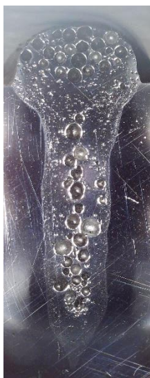
Abbildung 2 Schweißnaht; geschweißt mit PL = 10 kW, 33 mm/s, FL: - 6 mm
