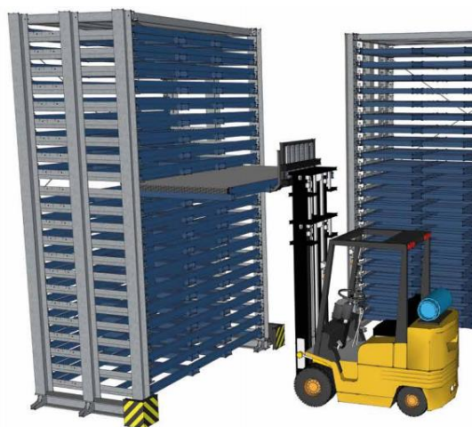
Abbildung 17: Turmlager ohne Schwenkkran /Böckelt Tower, 2016/
