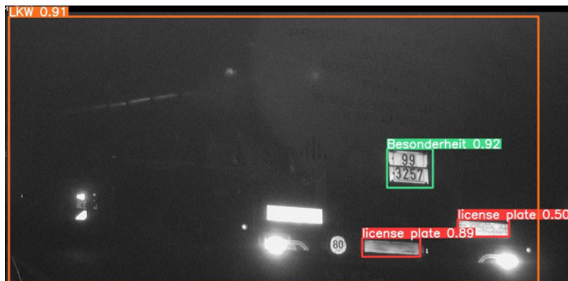
Abbildung 5.5: Objekte auf einem LKW erkannt durch YOLOv5
