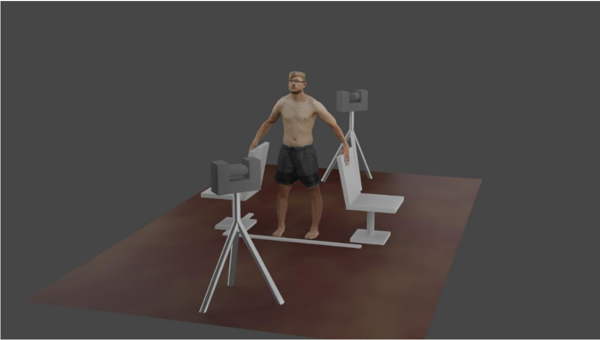
Abbildung 24 : Modellaufbau des Laserscans. Erster Scan mit im Vordergrund positioniertem Scanner, zweiter Scan mit Scanner an Position im Hintergrund
