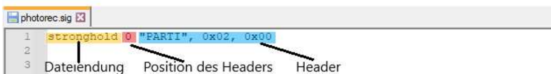
Abbildung 1: Beispiel einer photorec.sig mit Dateiendung, Position des Headers und Header
