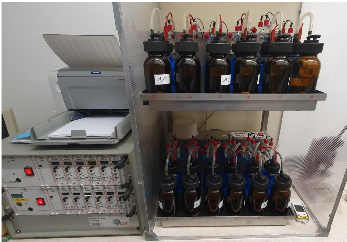
Abbildung 7: Aufbau des manometrischen Respirometers beim Versuch
