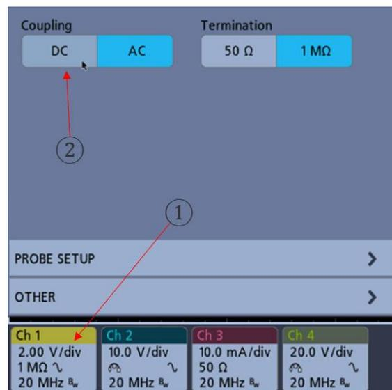
Abbildung 16 Kopplung am Oszilloskop einstellen
