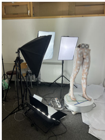
Abbildung 6: Abbildung des photogrammetrischen Aufnahmesystemes aus seitlicher Perspektive
