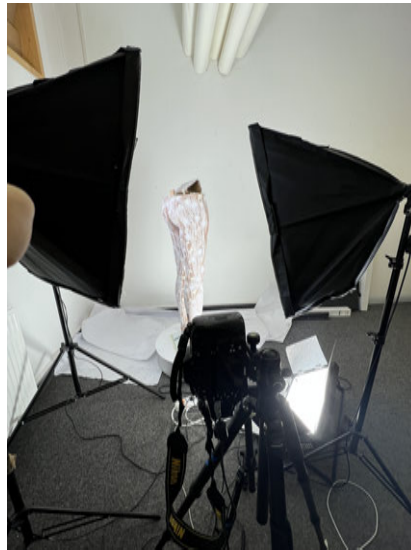
Abbildung 5: Abbildung des photogrammetrischen Aufnahmesystems aus Blickrichtung der späteren Erstellung der Aufnahmen
