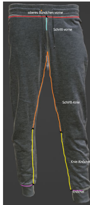
Abbildung 46: Abbildung der markierten Messstrecken mit Benennungen auf der Vorderseite der Hose, für die Vermessungen
