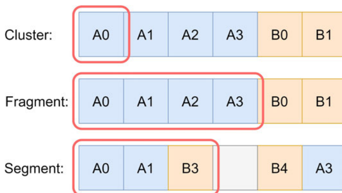
Abbildung 3.5: Schematische Darstellung der Unterscheidung der Begriffe Cluster, Fragment und Segment
