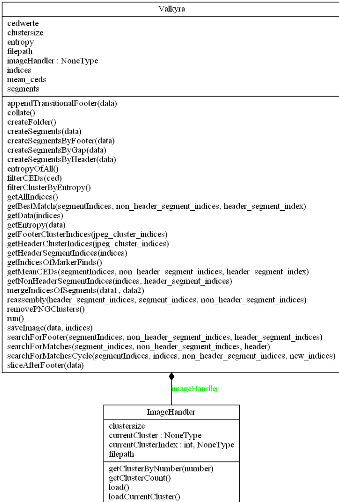
Abbildung 3.3: Klassendiagramme der Klassen Valkyra und ImageHandler des Prototyps
