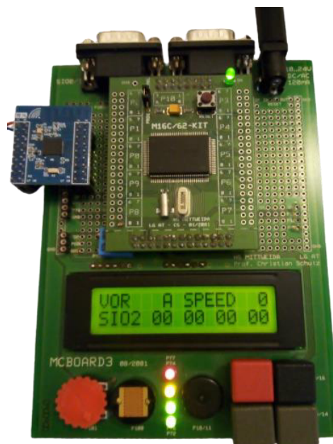
Abbildung 31: Testaufbau MCU M16c62 und nRF 52832
