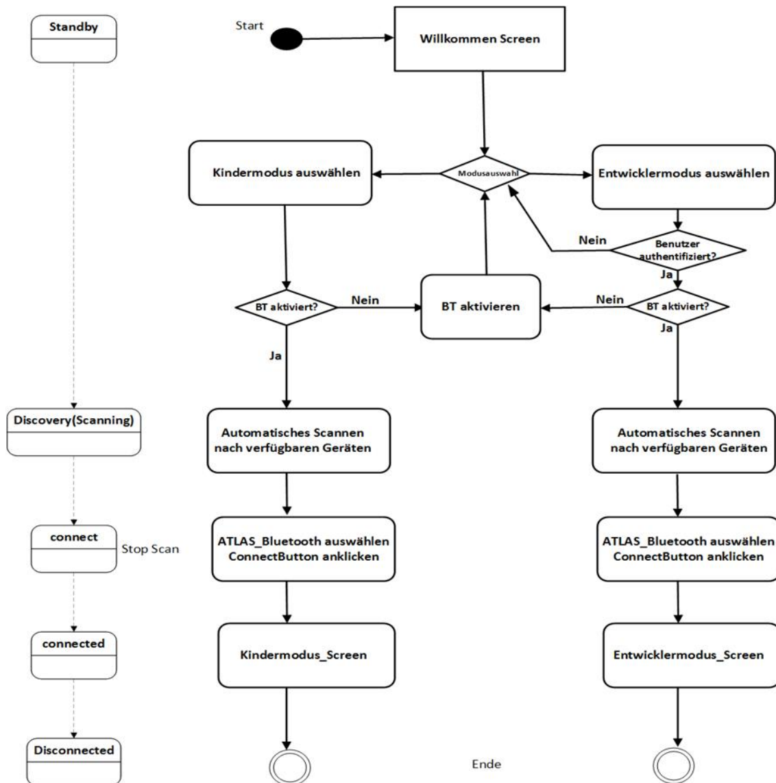
Abbildung 21: Flussdiagramm der App (UI)
