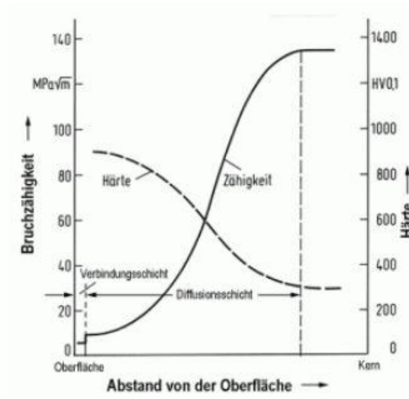
Abbildung 4: Verlauf von Härte und Zähigkeit bei nitrierten Oberflächen
