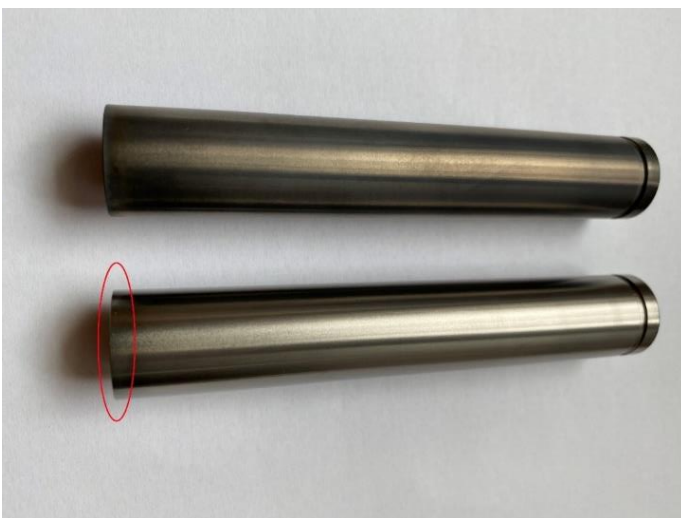
Abbildung 30: Optischer Vergleich von nitrierter (oben) und gestrahlter Achse (unten)
