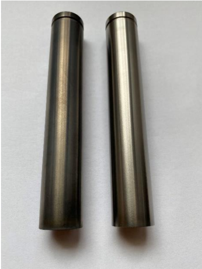
Abbildung 1: nitrierte und gestrahlte Achsen
