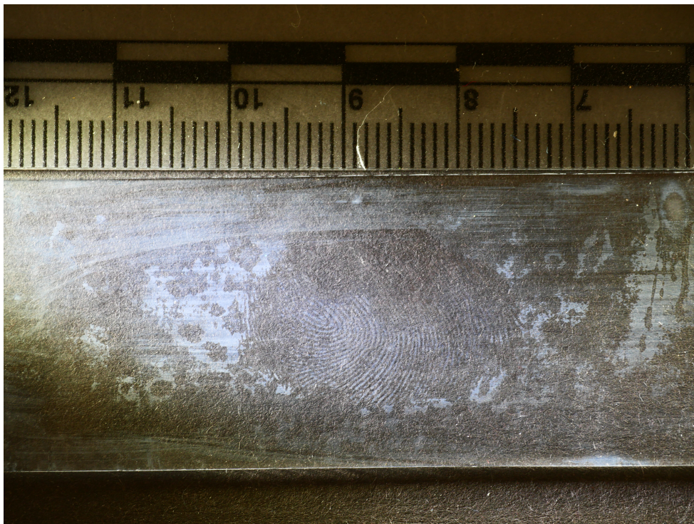
Abbildung 51: bedampfender Objektträger mit linkem Daumen bei einer Bedampfungszeit von 20 Minuten sowie -0,8 bar
