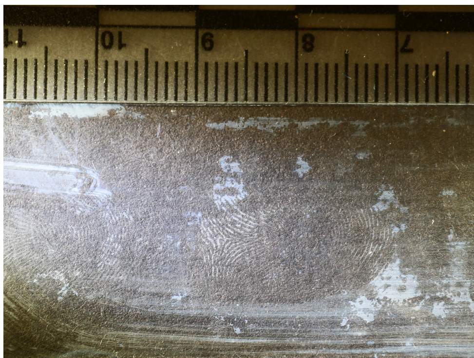
Abbildung 53: bedampfender Objektträger mit rechtem Zeigefinger bei einer Bedampfungszeit von 20 Minuten sowie -0,8 bar
