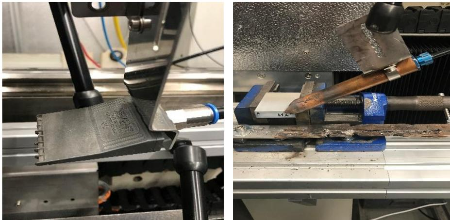
Abbildung 12: Cross-Jet Düse (Links) und Schutzgasdüse (Rechts)
