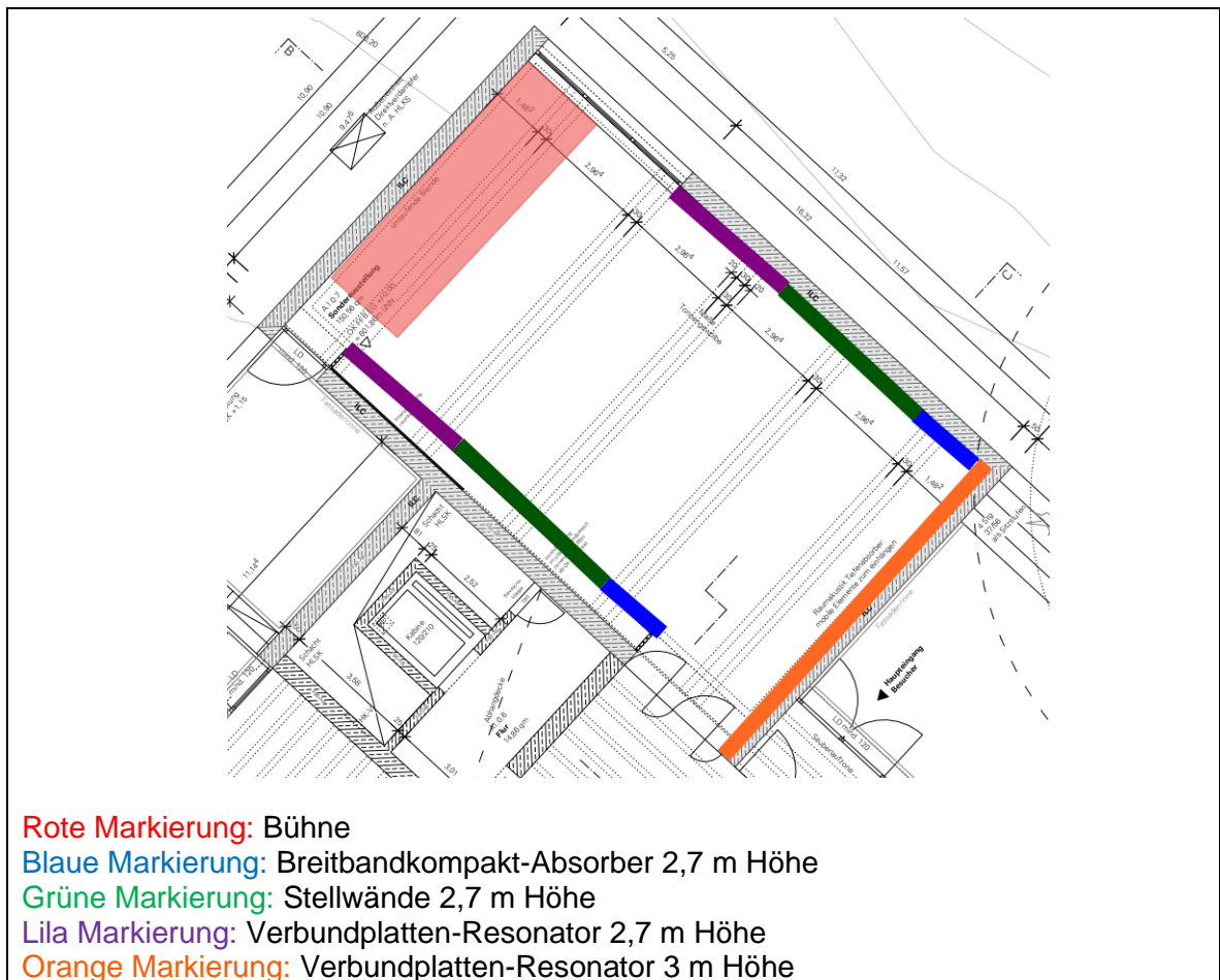
Abbildung 23: Wandmaßnahmen Vortrag, eingetragen in Grundriss Meck Architekten [27]
