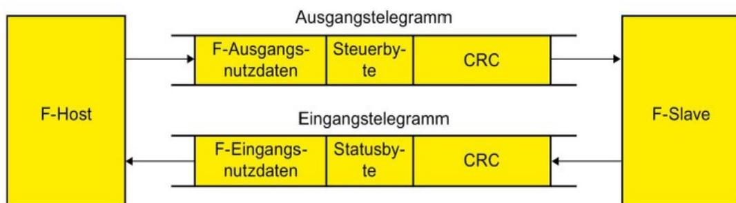
**Abbildung 26 Aufbau der F- Telegramme**
