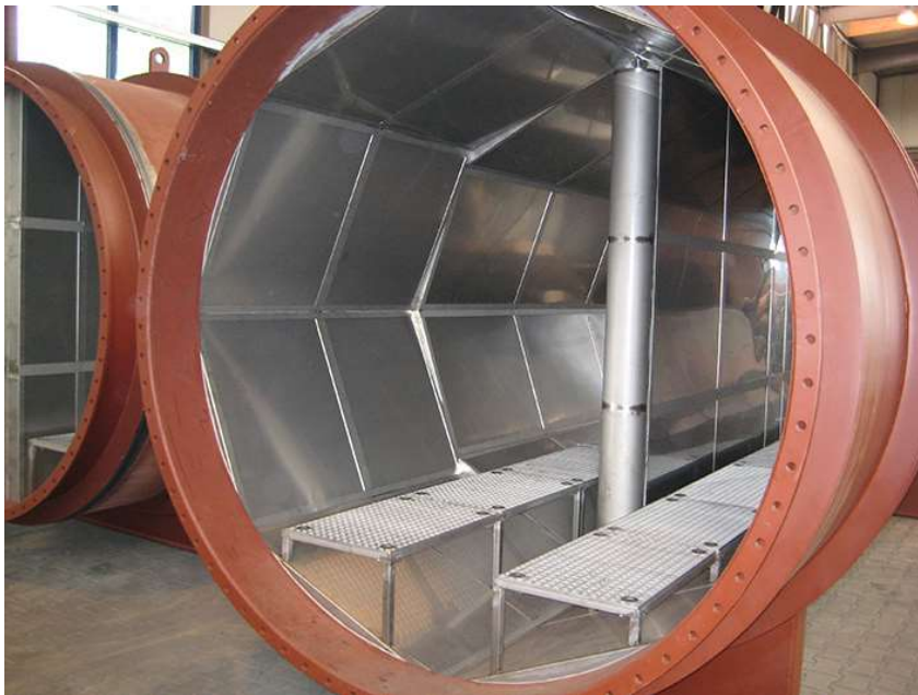
Abbildung 11 Schalldämpfender Schornstein beim Hersteller (Quelle: Niessing Anlagenbau)
