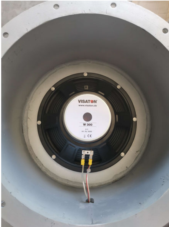
Abbildung 46 Lautsprecher im Testkanal ( Quelle: ALS GmbH)
