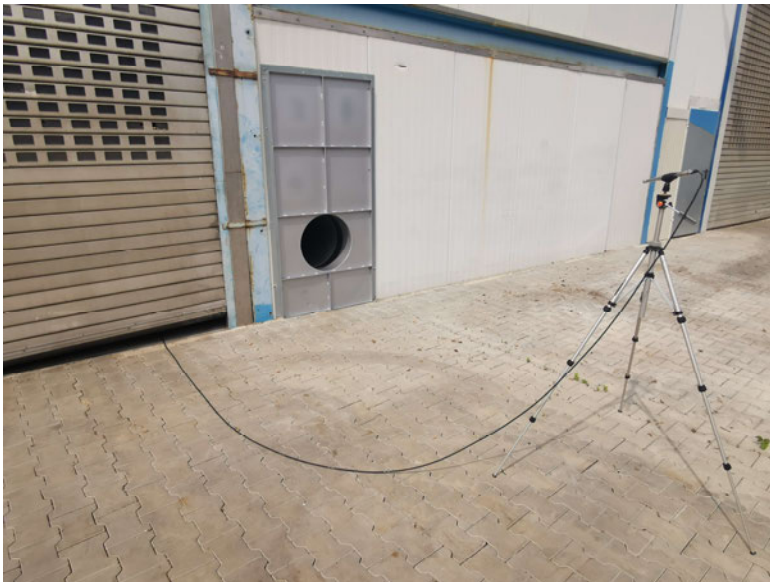
Abbildung 49 Messmikrofon am Prüfstand (Quelle: ALS GmbH)
