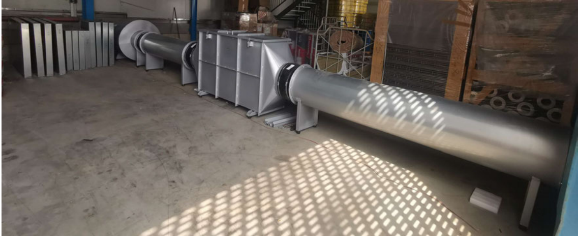
Abbildung 44 Aufgebauter Prüfstand Vorderseite mit Testkulissen ( Quelle: ALS GmbH)
