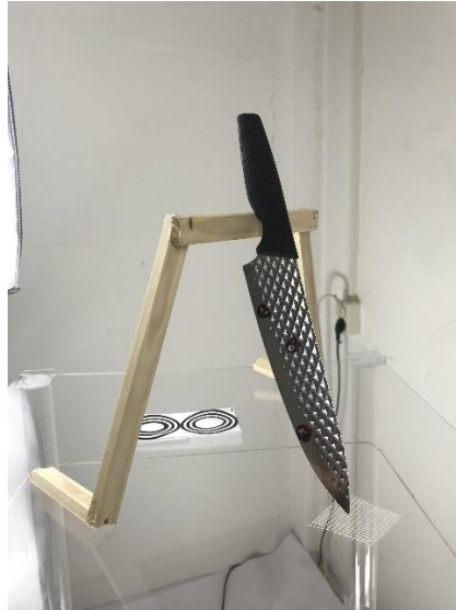
Abbildung 9: Messerhalterung in Form eines Holzgestells inkl. Wundgitter als Rutschschutz
