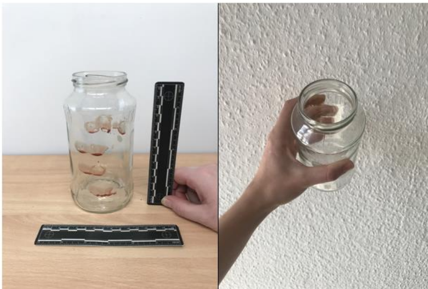
Abbildung 8: Kontaktspur auf dem Glasmantel mit Maßstab (links) und Griffgeschehen (rechts)
