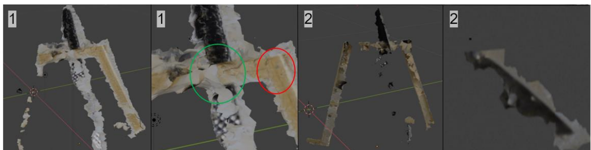
Abbildung 23: Qualitativer Vergleich der optimierten Messermodelle in Meshroom (1 - ohne Polfilter, 2 - mit Polfilter)
