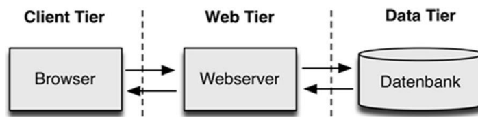
Abbildung 6: 3-Tier-Architektur einer Webanwendung
