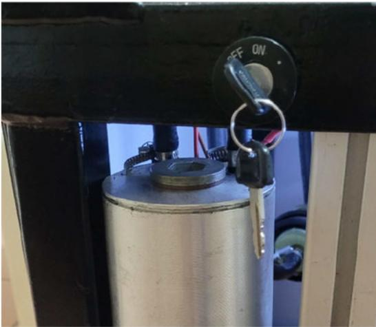
**Abbildung 24: Schlüsselschalter für Benzinpumpe**
