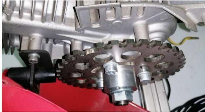
**Abbildung 36: Hallsensor mit Halter und Inkrementenrad**
