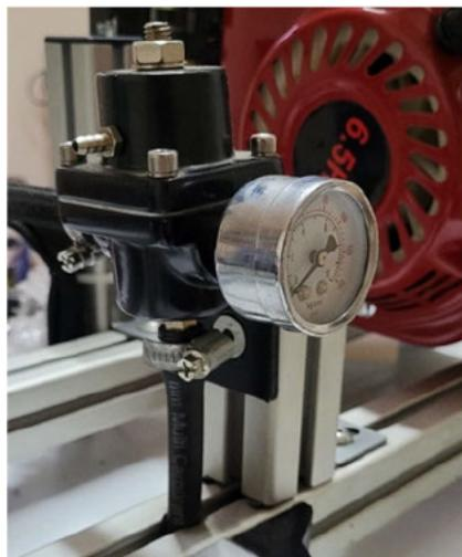
**Abbildung 26: Benzindruckregler im verbauten Zustand**
