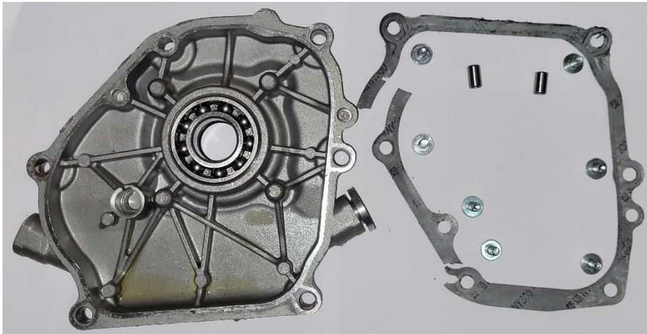
**Abbildung 21: Stirndeckel mit Dichtung**
