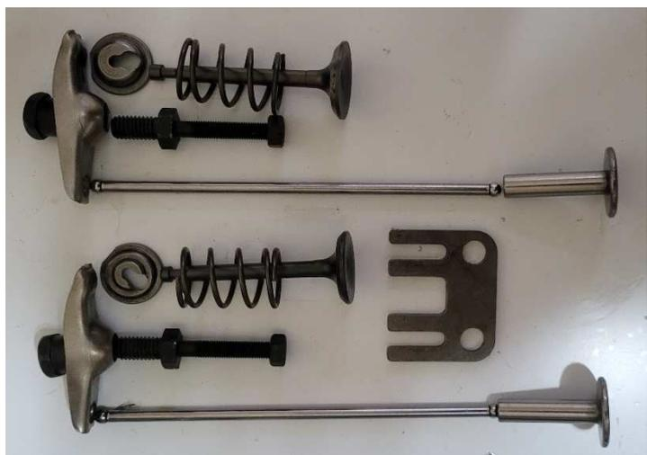
Abbildung 28: Ventiltrieb GX200
