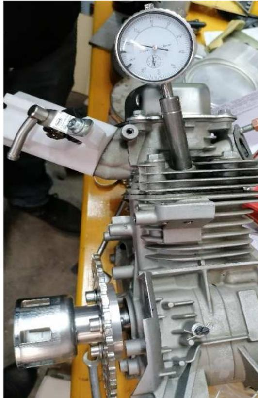
Abbildung 37: O.T. - Messung mit Messuhr
