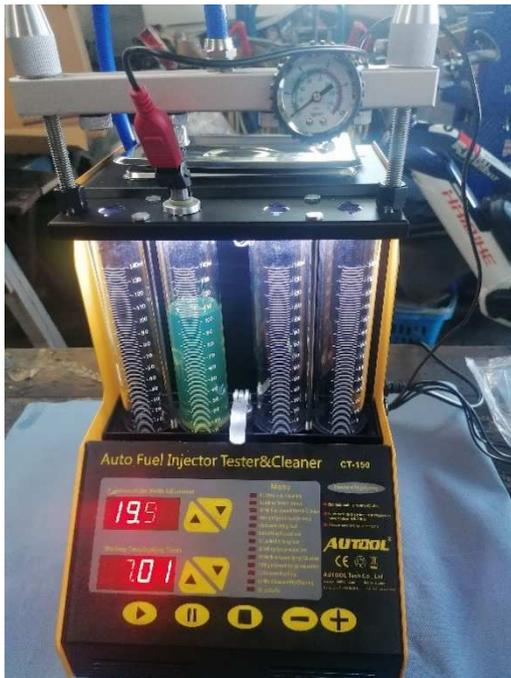
**Abbildung 14: Versuchsaufbau mit dem Injektortester**
