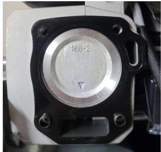
**Abbildung 30: Kolbenfläche GX200**
