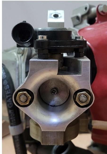
Abbildung 31: Drosselklappe im eingebauten Zustand
