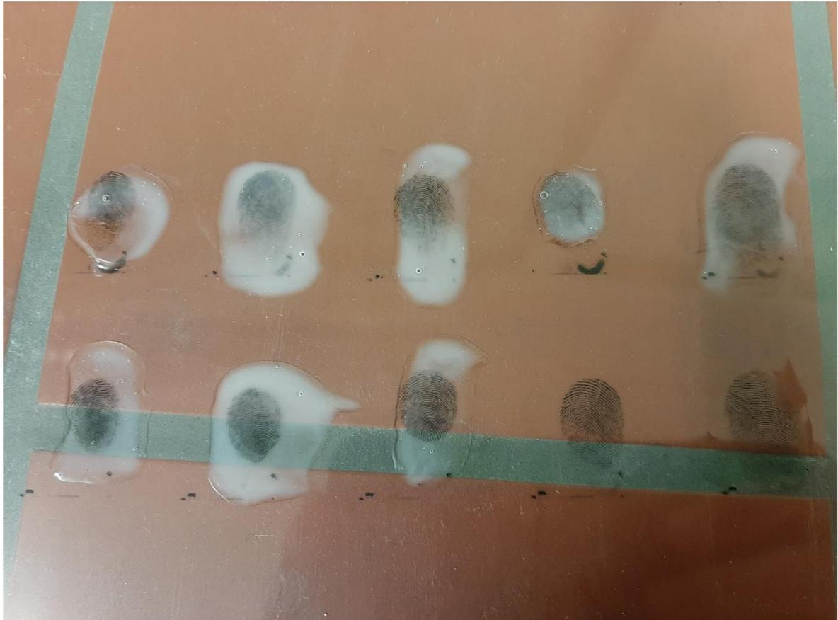
**Abbildung 29:** Abbildung des getrockneten, mit den Mischmethoden aus Tabelle 11 bearbeiteten Fakematerials; Von oben links startend: Test 1, Test 2, Test 3, Test 4, Test 5, Test 6, Test 7, Test 8
