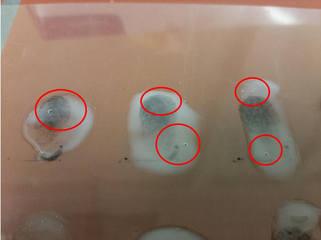
**Abbildung 49: (Von links nach rechts: Test 1; Test 2; Test 3) Die Luftblasen im Bild werden durch die roten Umrandungen markiert**
