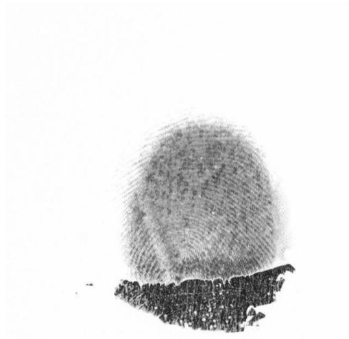
**Abbildung 17: Abgelehnter Fake des linken Daumens bei zehn Druckdurchgängen und einem klebengebliebenen Stück getrockneter Tinte**
