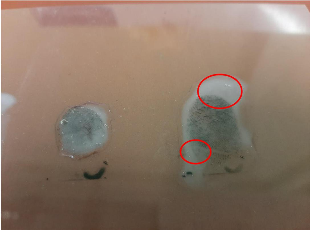
**Abbildung 50: (Von links nach rechts: Test 4; Test 5) Deutliche, große Luftblasen sind bei Test 4 zu sehen; Die Luftbasen in Test 5 sind durch rote Umrandungen markiert**
