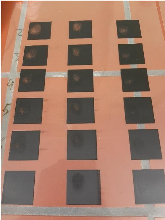
**Abbildung 14: Bilder der gedruckten Fingerabdrücke mit den Druckdurchgängen 1-7**
