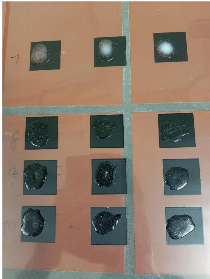
**Abbildung 52: alte Fakes aus dem Praktikumsbeleg; auffällig sind die deutlich zu sehenden Luftblasen und die Kompaktheit der Fakes**
