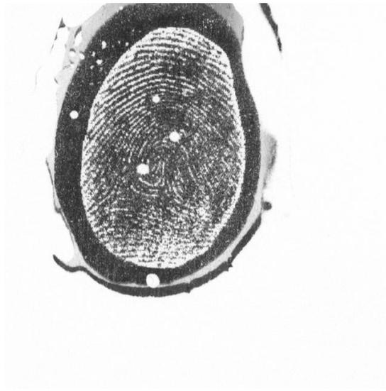
**Abbildung 92: Fakefingerabdruck des Fingers r4 aus Reihe 1 (linke Seite) der Abbildung 48 mit weißem Pulver**
