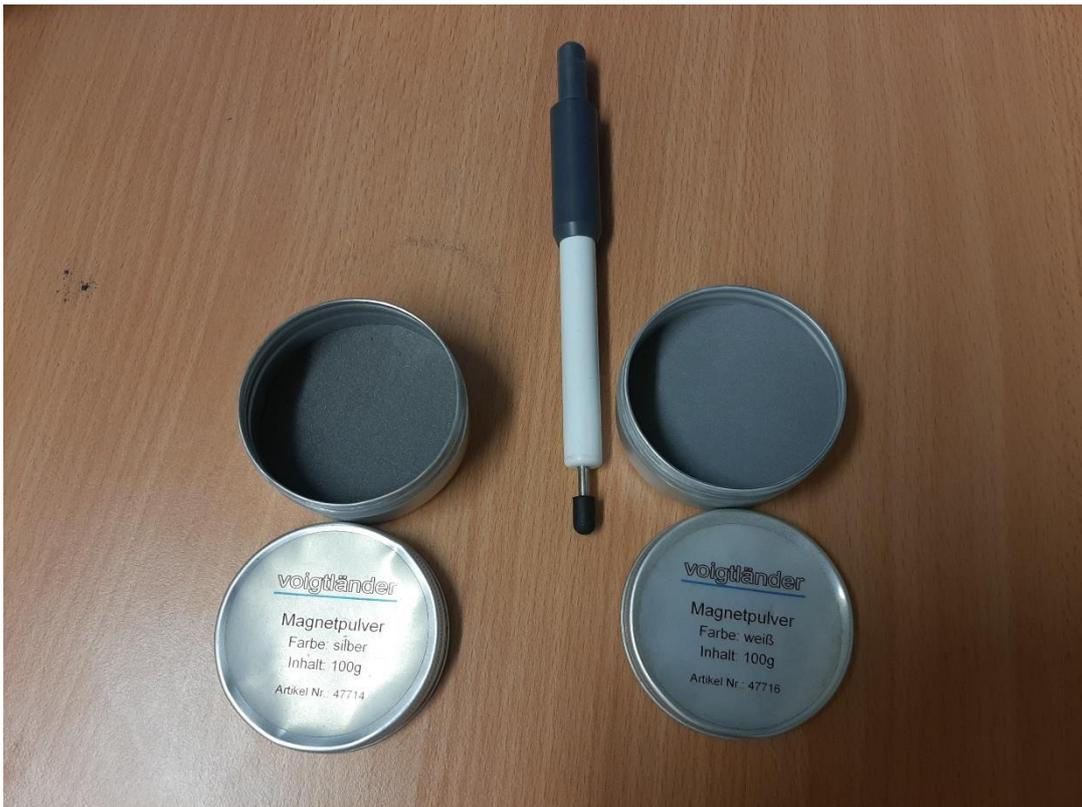
**Abbildung 27: Magnetpulver mit zugehörigem Magnetstab zum Auftragen des Pulvers auf die Abdrücke in Versuchsreihe 4 (siehe Abschnitt 4.4)**
