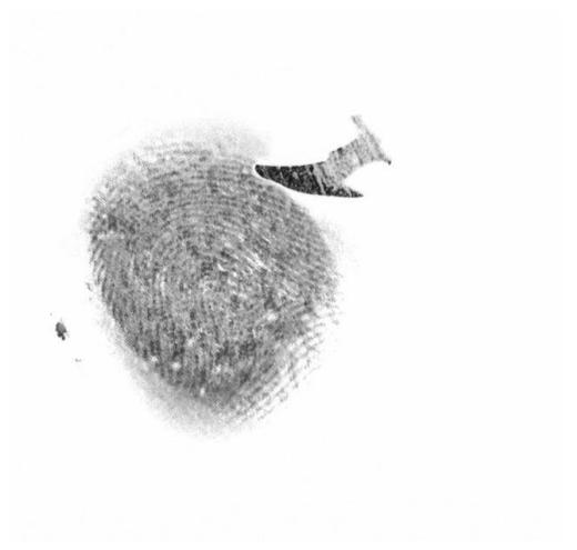
**Abbildung 20: Abgelehnter Fake des linken Zeigefingers bei zehn Druckdurchgängen und einem klebengebliebenen Stück getrockneter Tinte**
