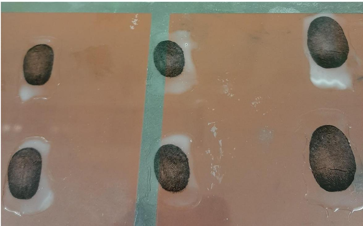
**Abbildung 30: Testfakes der Versuchsreihe 2; Reihe 1 mit 2 T. Glycerin und Reihe 2 nur mit 1 T. Glycerin; Anordnung der Finger für beide Reihen (von links nach rechts): Mittelfinger, Zeigefinger, Daumen**
