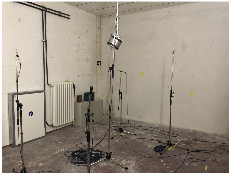
Abbildung 4.2: Messaufbau im Empfangsraum
