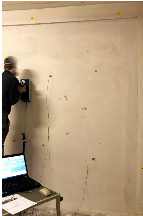
Abbildung 4.3: Messaufbau mit dem Midi-Hammerwerk an die Trennwand
