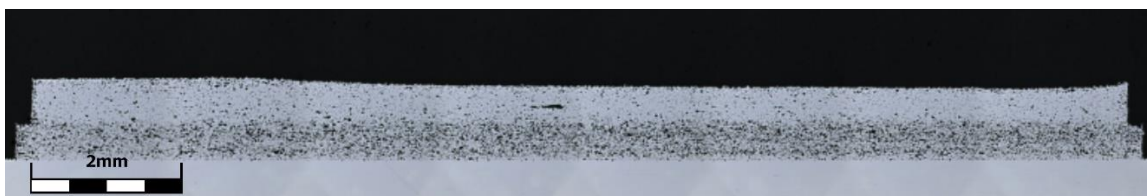
Abbildung 60: Überhöhung des mit einer Schichtdicke von 3 \mu\text{m} erzeugten Bauteils. Die Umsetzung von Schichtdicken kleiner 5 \mu\text{m} war an der genutzten Anlage nicht möglich.
