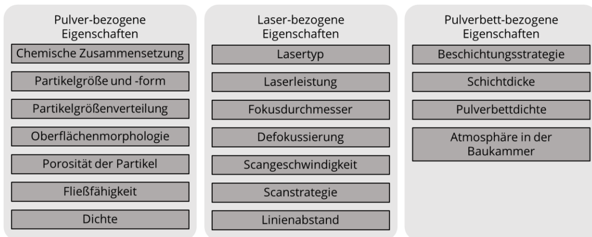
Abbildung 6: Übersicht über eine Auswahl der wichtigsten Prozessparameter im SLM. Quelle: [10].
