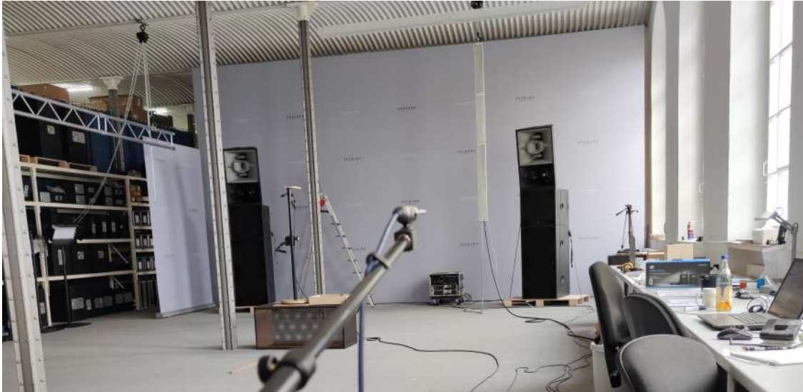
Abbildung 5.1: Aufhängung des IBeam an einem Kettenzug und Messmikrofon, die beschriftete Version ist dem Anhang beigelegt
