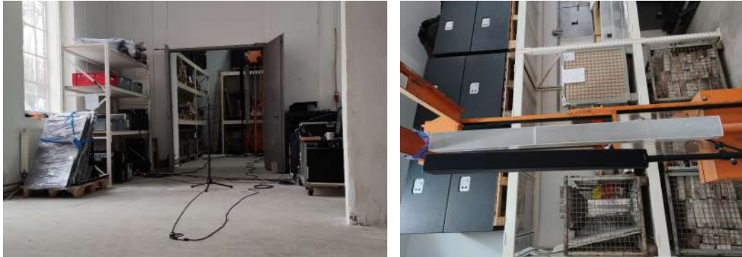
Abbildung 5.13: Metalltüre, Lautsprecher und Mikrofon an Messposition 0
