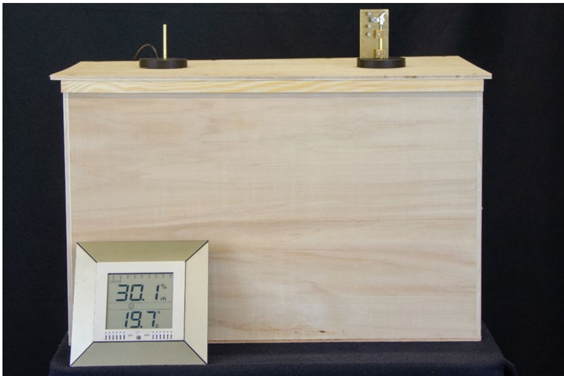
Abbildung 18 – raumakustisches Modell aus Sperrholzplatten mit eingesetztem Messmikrofon (links) und Schallquelle (rechts); im Vordergrund: Thermometer/Hygrometer Kombimessgerät
