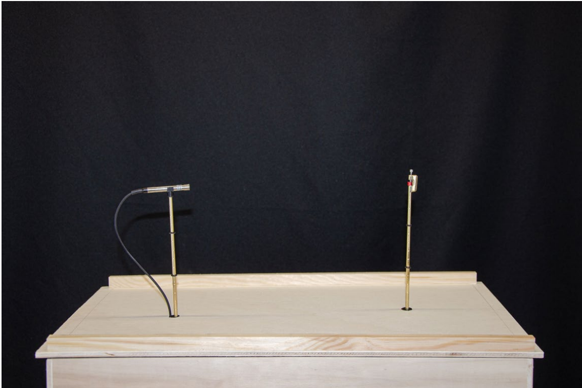
Abbildung 23 - Aufbau des Messmikrofons (links) und der Schallquelle (rechts) auf dem Deckel des raumakustischen Modells
