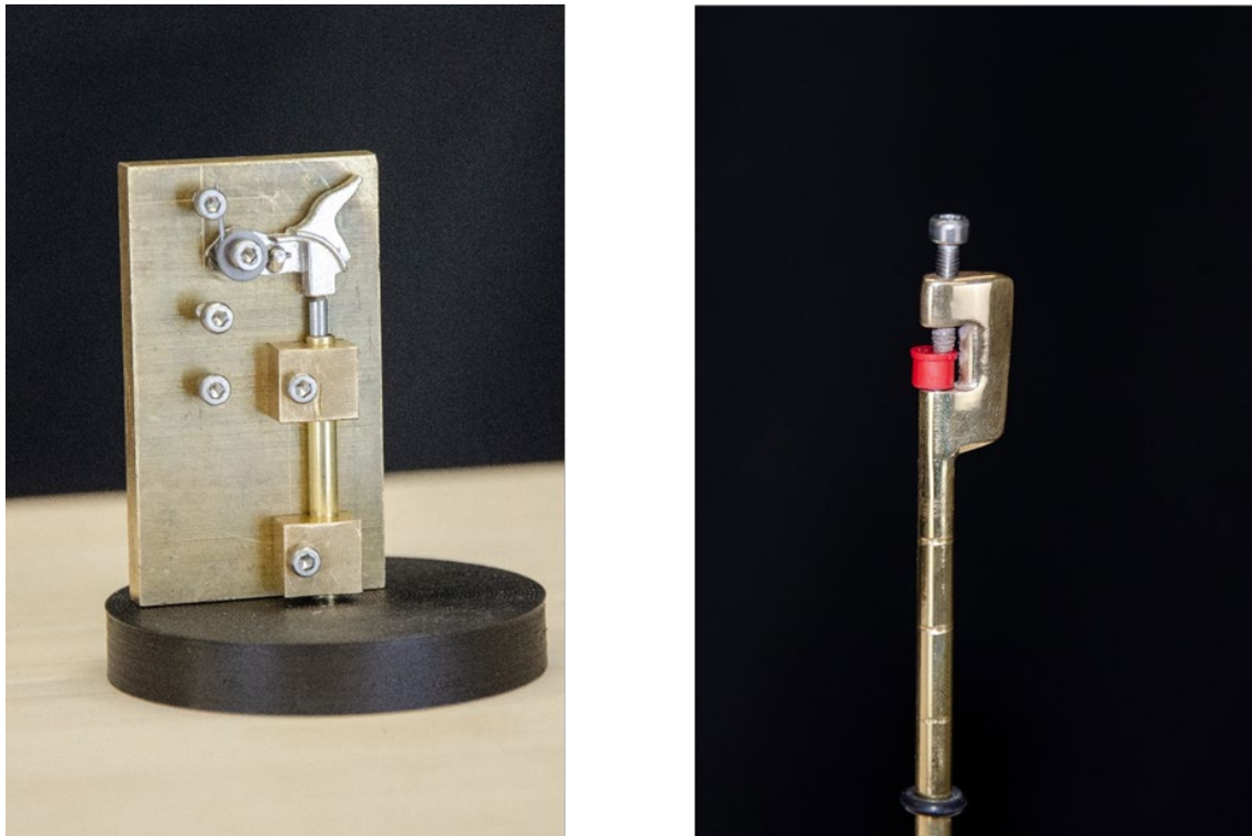
Abbildung 20 – links: Grundplatte aus Messing mit Hahn und Schlagfeder; rechts: eingesetztes Zündplättchen (rot) im Auslösekopf der Schallquelle;
