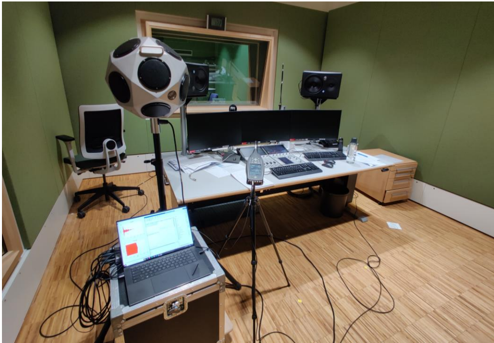
Abbildung 50: Messaufbau im Senderraum (Exemplarisch für RiR-Konstruktion Variante 1)
