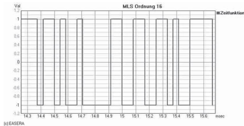
Abbildung 4: Ausschnitt aus einer MLS-Folge der Ordnung 16 bei einer Abtastrate von 24 kHz (Ahnert und Feistel, 2010)
