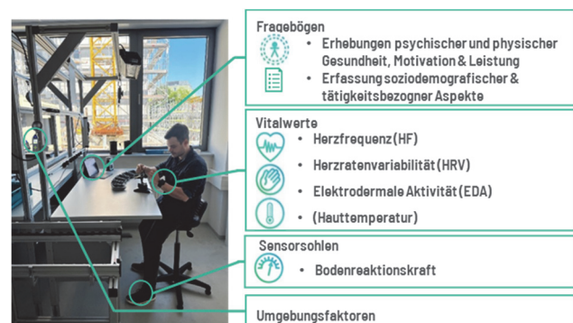
Abb. 3: Versuchsarbeitsplatz mit Erfassung von Umgebungsfaktoren und Vitalparametern
