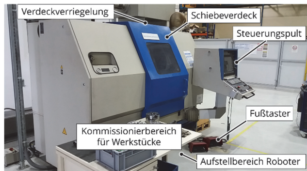
Abbildung 4: Drehmaschine Niles-Simmons N10 bei ICM
