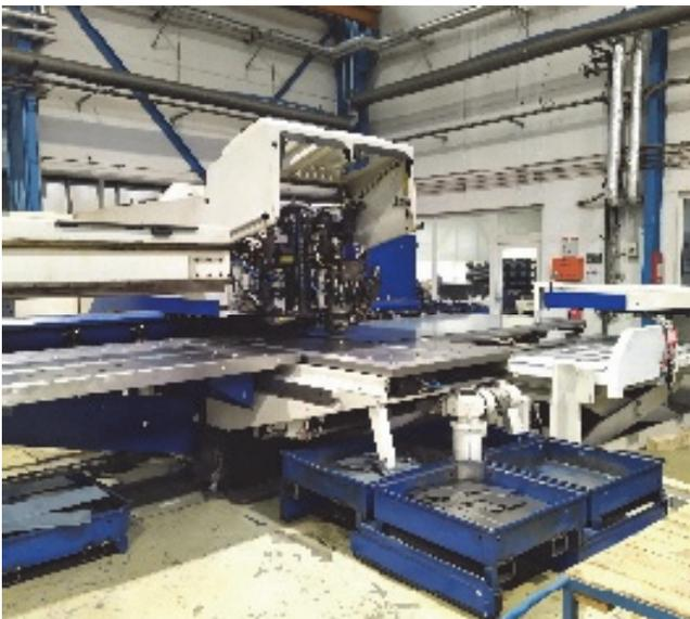
Abbildung 2: Laser- Stanzmaschine bei Caleg
