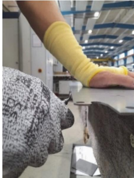
Abbildung 3: Beispiel für manuellen Entgratvorgang
