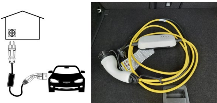
Abbildung 10: links: Darstellung Ladebetriebsart 2 [12]; rechts: Ladekabel mit ICCB [eigene Darstellung]
