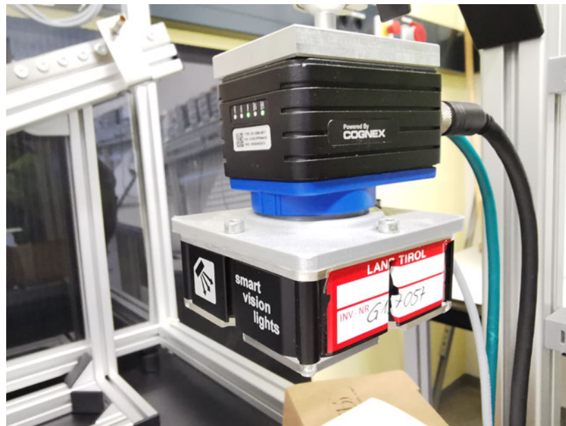
Abbildung 3.1: Aufbausituation Kamera Cognex
