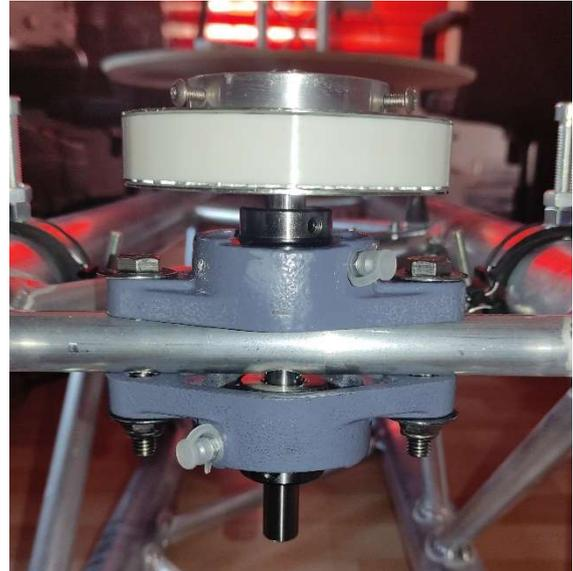
**Abbildung 5-4: Gegenlager mit Umlenkrolle**
