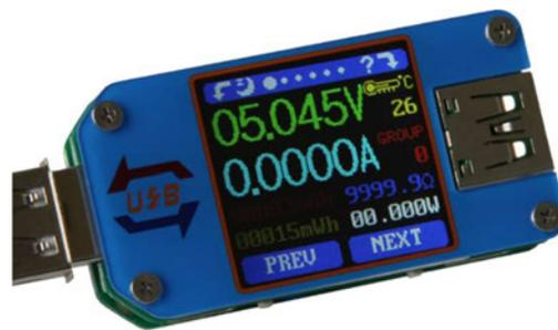
**Abbildung 7-1: USB-Tester zum Messen von Strom und Spannung
