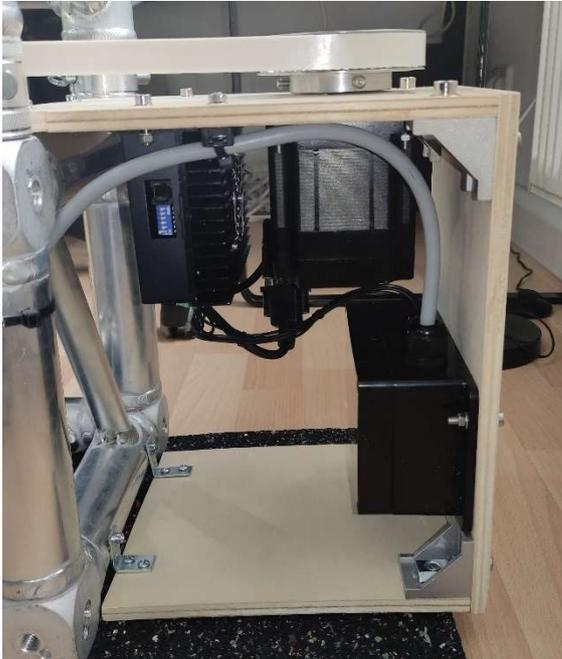
**Abbildung 5-3: Antriebssseite des Linearantriebs**
