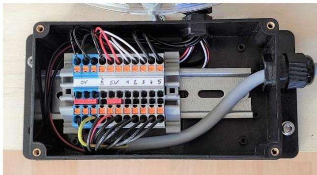
**Abbildung 5-9: Anschlussdose für die elektrische Verbindung der Bewegungsachsen**
